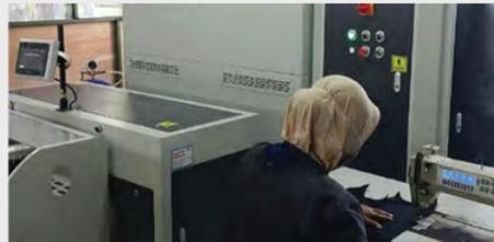
자동 다운 충전기 Down Filling Machine
